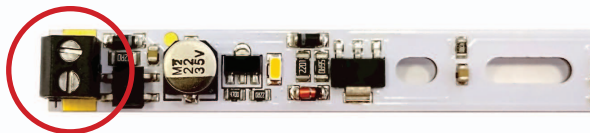
Abbildung 1: Schraubklemme zum Anschließen der Stromversorgung Figure 1: C-clamp to connect the power supply
